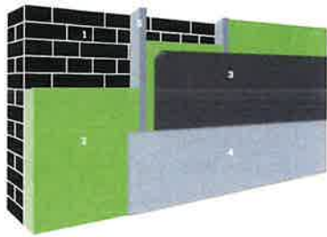
1. Buitenmuur | 2. Isolatie | 3. Vochtschermb | 4. Afwerkingslaag | 5. Stijl- en regelwerk (optioneel)
